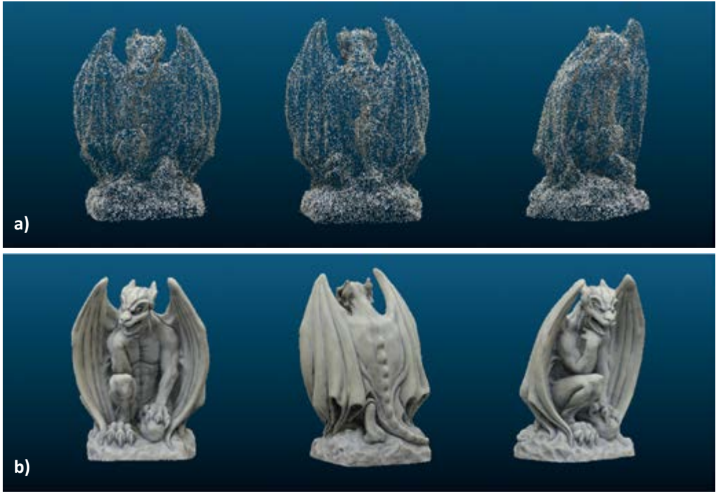
Il. 3. Etapy przetwarzania danych w technice SfM: a) geometria 3D utworzona na podstawie punktów charakterystycznych, b) „gęsta” chmura punktów. Źródło: opracowanie własne
